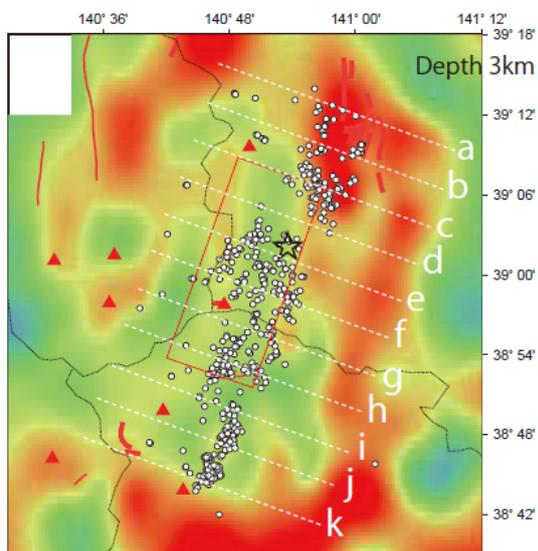
図8. 岩手・宮城内陸地震震源域における S 波速度分布. 西北西—東南東方向の断面図で示す. 白☆, 白○は, 2008 年岩手・宮城内陸地震緊急観測グループによる本震および余震(6/23-6/30, 7/2-7/7)を示す. 赤△は第四紀火山を示す. 赤■および□は活断層および地表地震変状の位置を示す. 左下: 深さ 3km における S 波速度分布. 赤四角は地震断層の概略を示す.
