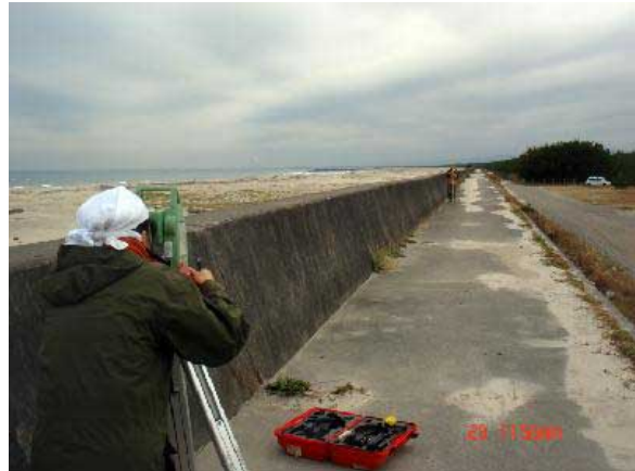
仙台平野南部亶理町におけるトータルステー ションを用いた地形測量調査風景
