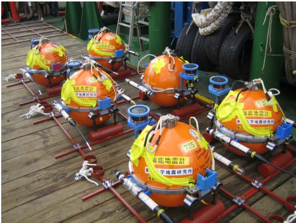
写真6 東北大学が借り上げた船舶上に積み込まれた海底地震計
