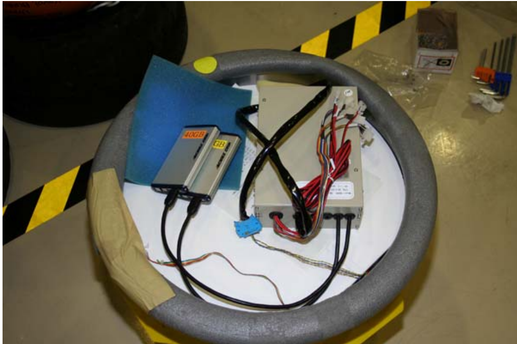
写真3 長期観測型海底地震計の組立作業
