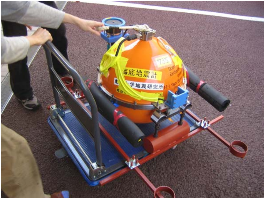
写真4 組み立てが完了した長期観測型海底地震計
