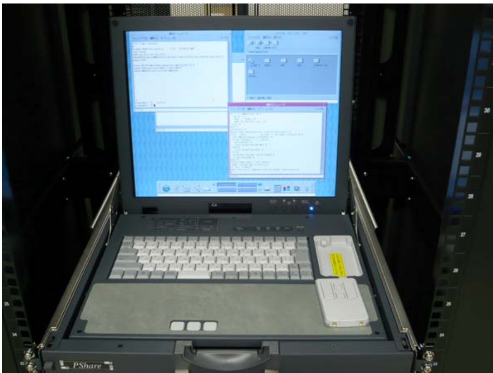
写真8 新規整備した海底地震計データの1次処理装置のシステムコンソール
