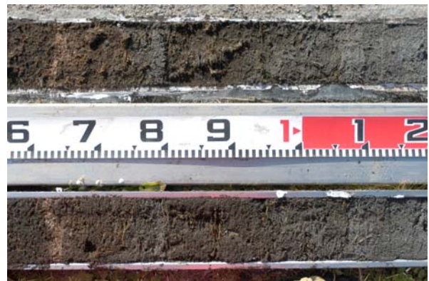
小型ジオスライサーを用いて採取された柱 状堆積物（山元町）
