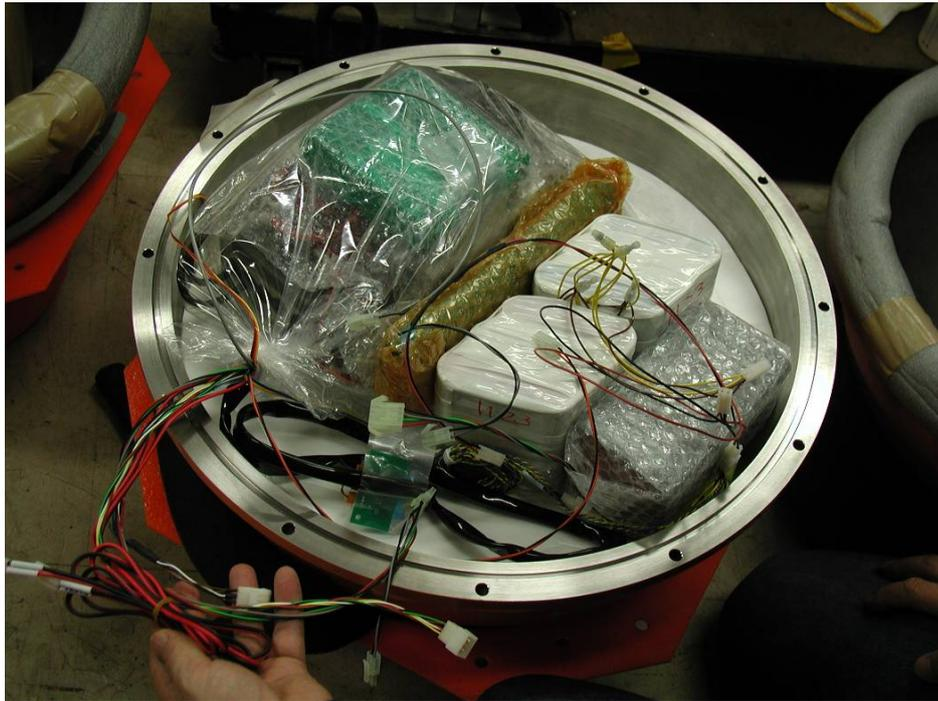
写真3 長期観測型海底地震計の組立作業
