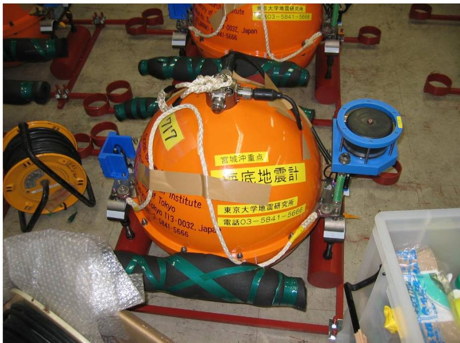
写真4 組み上げの完成した長期観測型海底地震計
