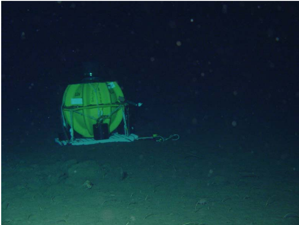
図4. 無人探査機「かいこう 7000」により設置した海底局
