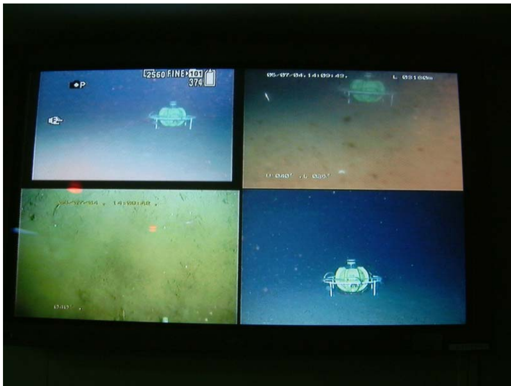
図 3. 2003 年に設置した海底局の設置状況を示す写真
