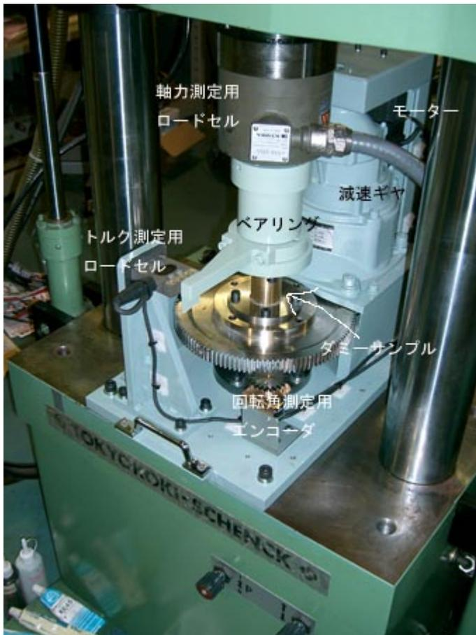
写真. 設計・作成した回転式変位試験機。外径 30mm、内径 20mm の同心円筒状の試料を標準として設計した。設計上の最大軸荷重は 12kN、最大トルクは 200N-m なので、標準寸法の試料を用いた場合の最大法線応力は約 15MPa、最大せん断応力は約 20MPa である。当初設計では回転角の分解能は 0.1 度。したがって、標準寸法の試料では変位分解能は約 20  $\mu$ m である。今後、変位分解能が 0.2  $\mu$ m になるよう改造する予定である。
